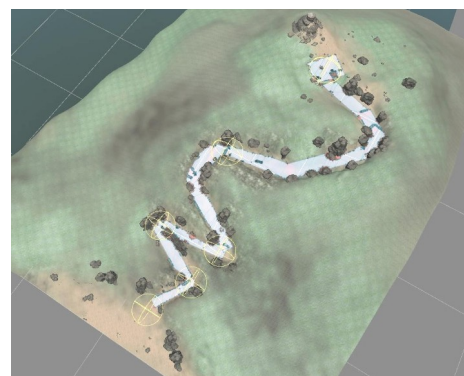
Il nav-mesh (il sentiero serpeggiante) e i trigger volumes sotto forma di sfere
