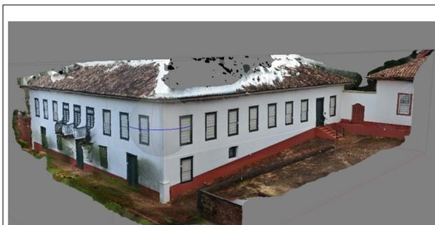
Figura 14: Il modello 3D di un edificio ricostruito con la tecnica della fotogrammetria. Fonte wikipedia
